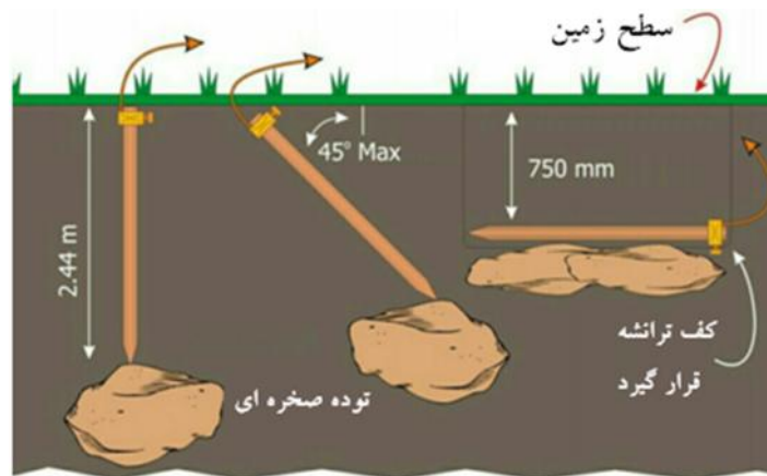
شکل (۲-۵): صورت‌های مجاز اجرای الکترودهای میله‌ای (۲۵۰.۵۳ Art: ۲۰۱۴ NEC)
