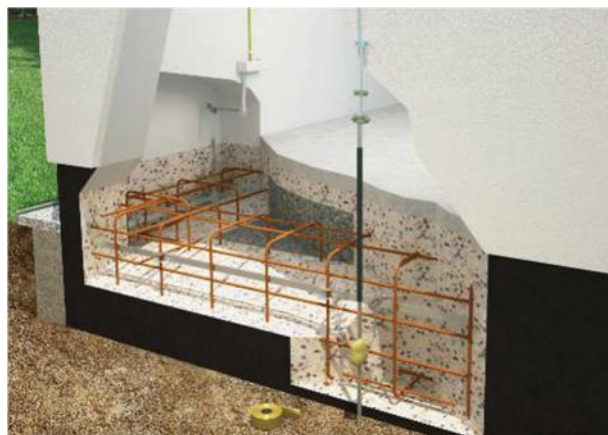
شکل (۲-۱۱): الکتروود مدفون در بتن
